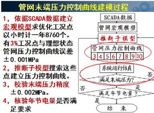
图4 管网压力控制曲线建模主要过程
